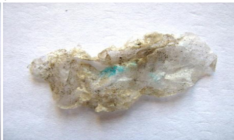
Рис. 2. Изменение внешнего вида полиэтилена под влиянием Aspergillus niger , где: а) ПЭ (с крахмалом) до эксперимента; б) ПЭ (с крахмалом) после эксперимента
