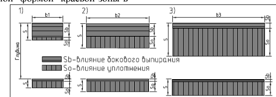
Рис. 2. Схемы влияния боковой составляющей деформации грунта на общую осадку основания, в зависимости от ширины подошвы фундамента
