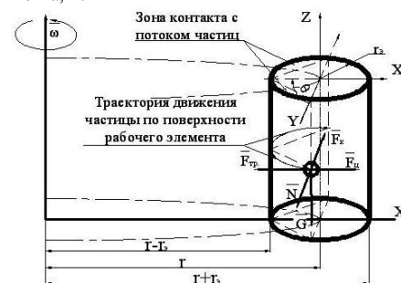
Рис. 2. Силы, действующие на частицу измельчаемого материала при ее движении по поверхности рабочего элемента дезинтегратора
